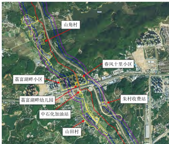
图1 高后果区影像图（红色为管线、蓝色为缓冲区边界、紫色为潜在影响半径）
