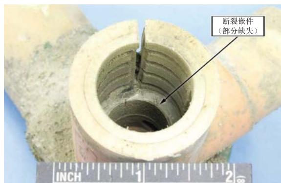
图4 Aldyl A聚乙烯三通失效图
