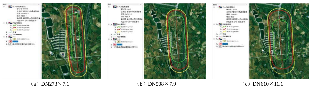
图 2 不同管径成品油管道个人风险等值线图
