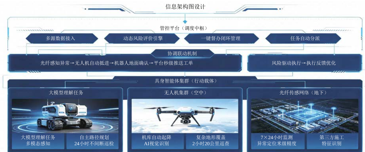
图1 具身智能体集群协同巡检架构
