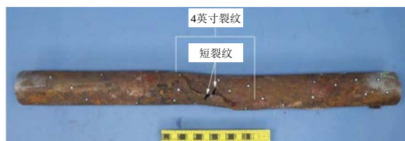
图3 蒸汽管道失效图
