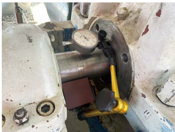
图2 密封安装面垂直度检查
