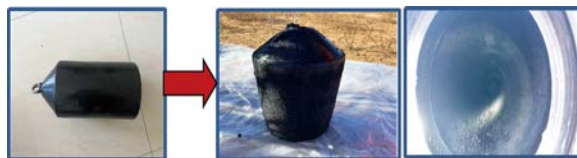
图1 高密度泡沫清管器清管前后对比
