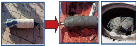
图2 泡沫涡流检测器清管前后对比
