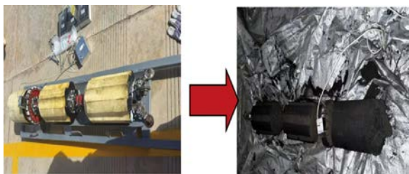
图4 检测完成后球体回收
