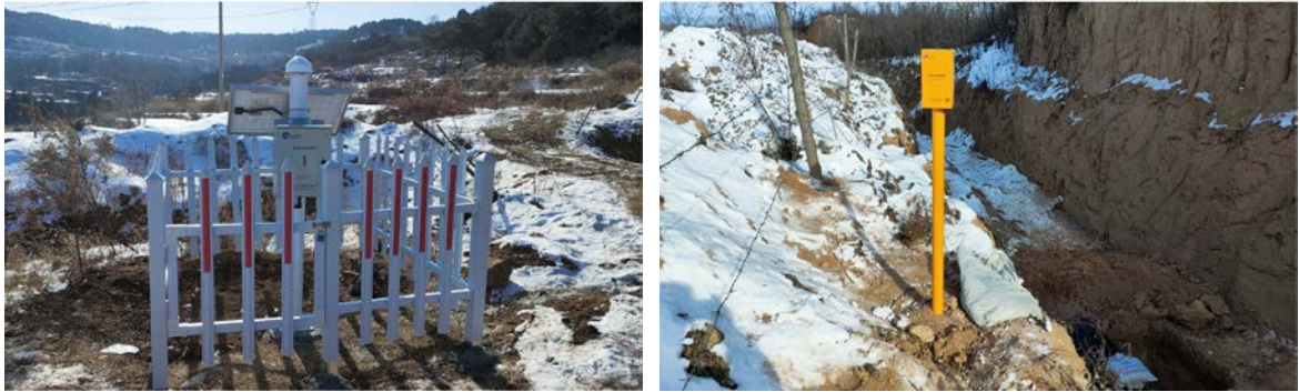
图5 现场监控（左）及智能阴极保护测试桩（右）
