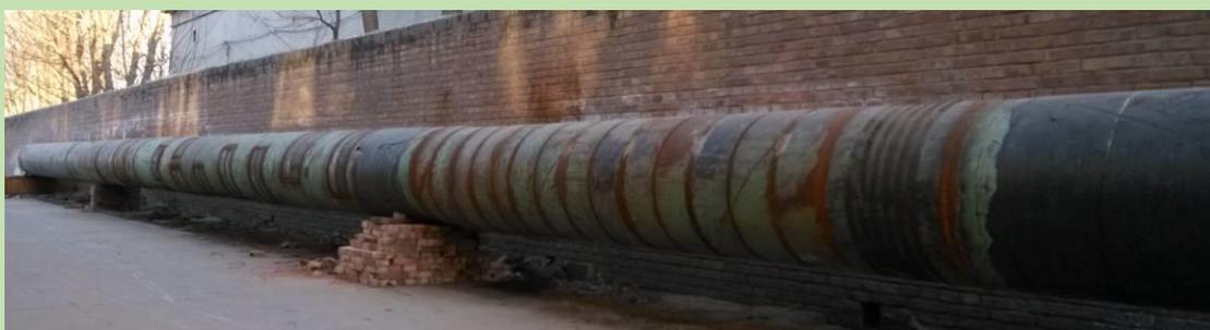
图 12 环焊缝缺陷漏磁内检测牵拉试验管道图
